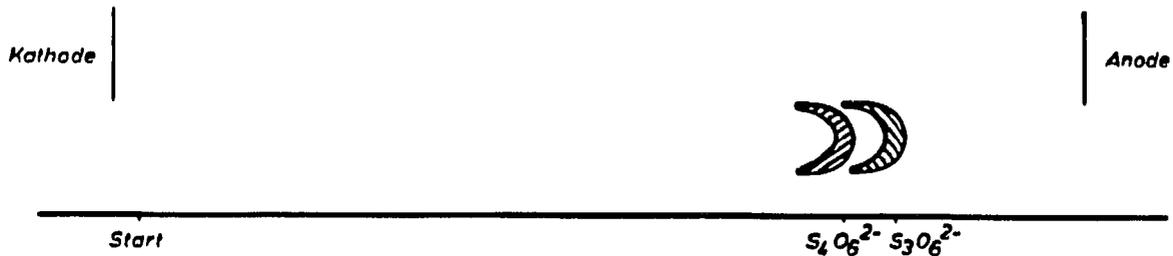
Fig. 5. Apparatur I: Nachweis der Zone durch Besprühen mit  $\text{AgNO}_3$ -Lösung.
